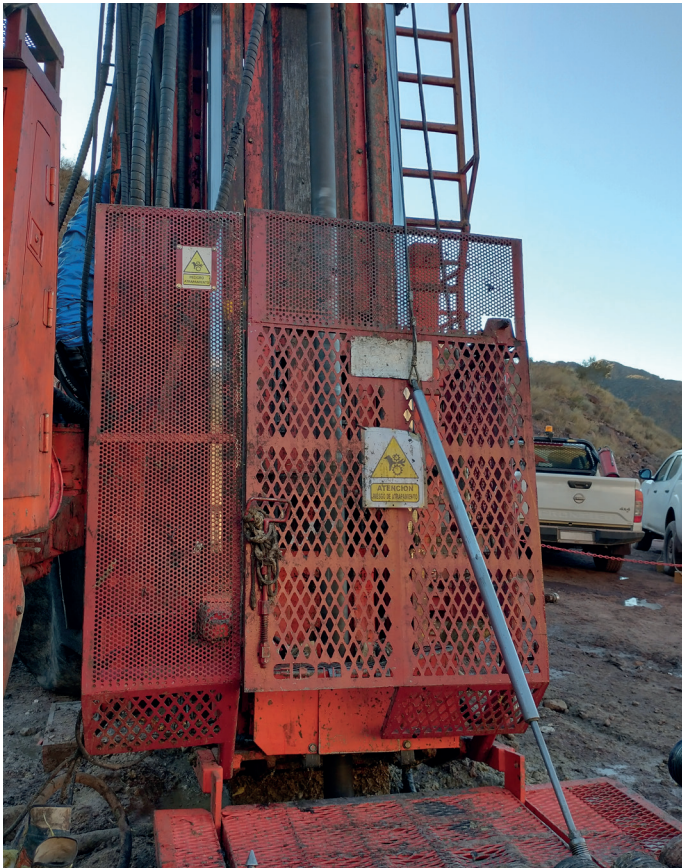
Resguardos físicos, del equipo de perforación, para evitar atrapamientos.
