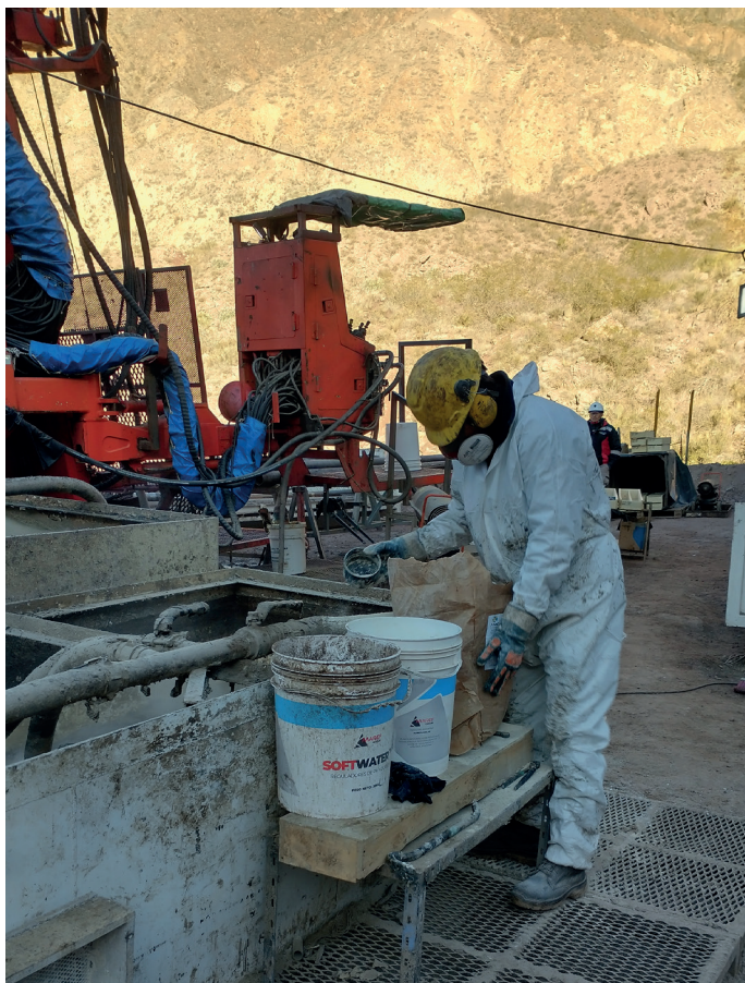
Ayudante de perforista colocando aditivos en pileta de lodos de perforación.
