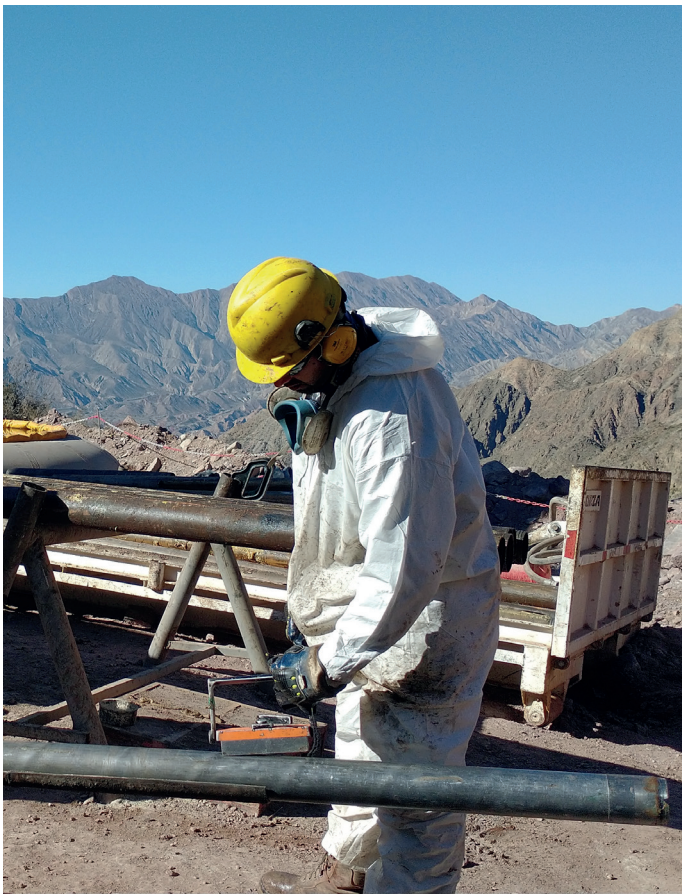
Ayudante de perforista utilizando herramienta magnética para levantar barra.
