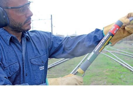
**3. Retirar la tapa lisa superior, donde se indica encender. La tapa inferior ubicada en el extremo que dice sujetar debe conservarse.**
