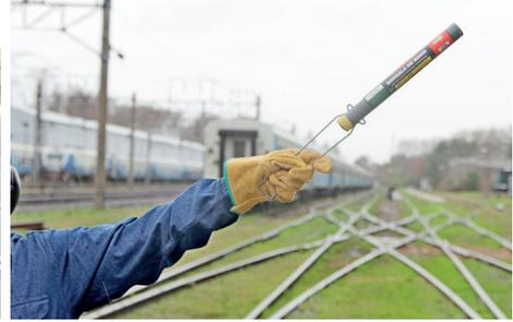
**4. Orientación de la bengala: desplazar el mango 180 grados hasta que quede trabado en las ranuras de seguridad, forman una misma línea con el tubo de la bengala.**
