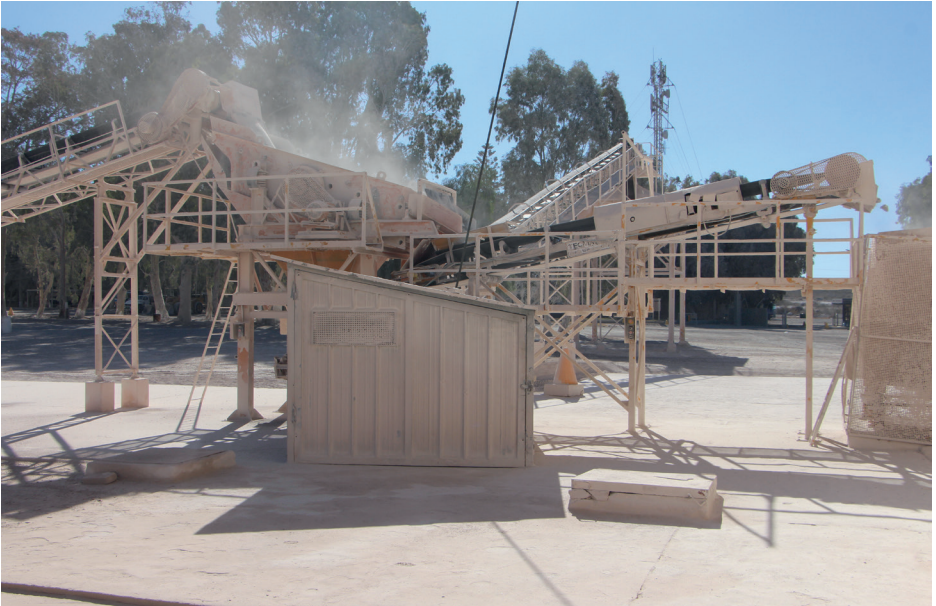
Clasificación granulométrica de piedra caliza
