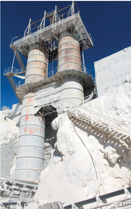
Hornos de calcinación de lecho mixto (carbón y piedra caliza)
