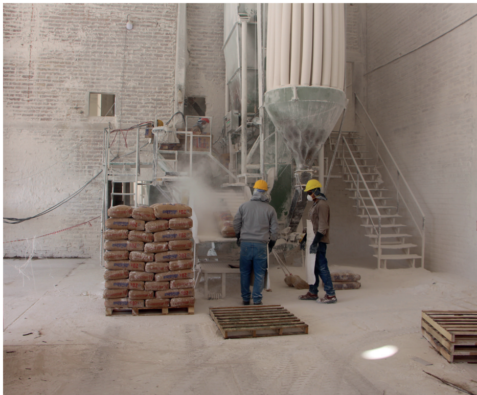
Embolsado de la cal y paletizado de bolsas
