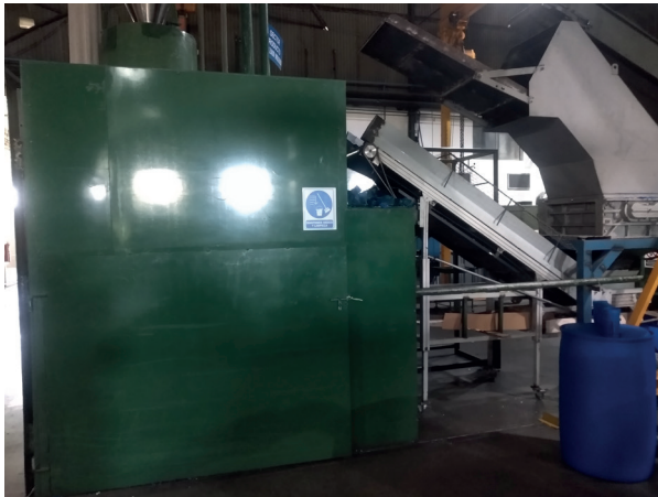
Trituradora encapsulada para disminuir el ruido
