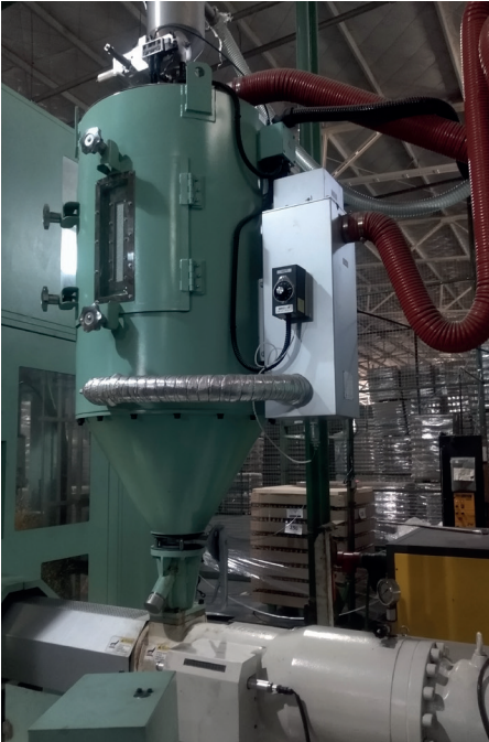
Alimentación con mangueras y tolva de secado
