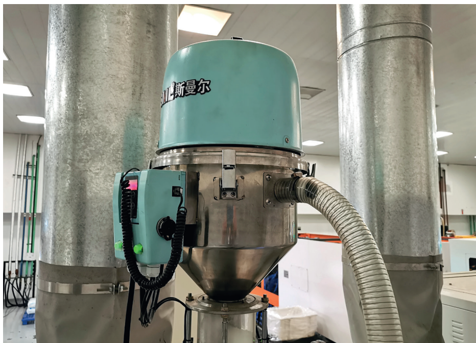
Alimentador automático de pellets por succión
