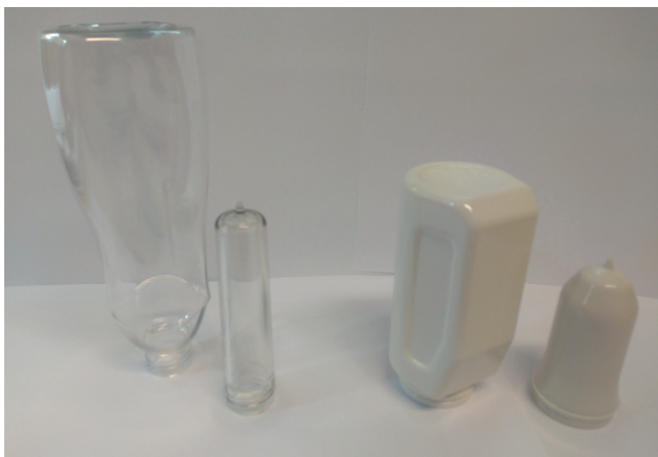
Preforma y forma final en el proceso de inyección soplado
