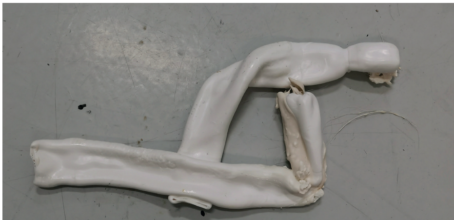
Scrap de manga en el soplado tradicional
