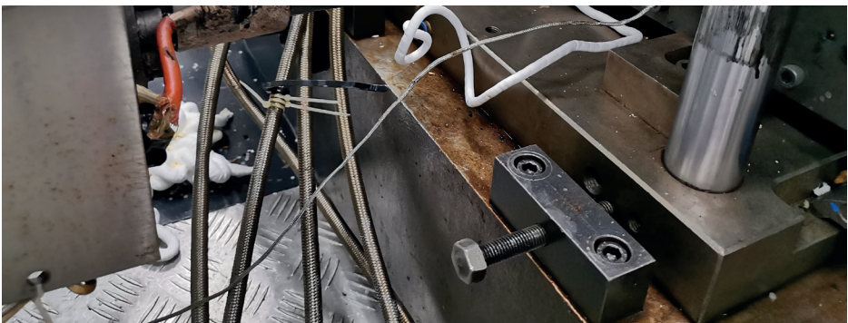
Apertura de tornillo durante la purga
