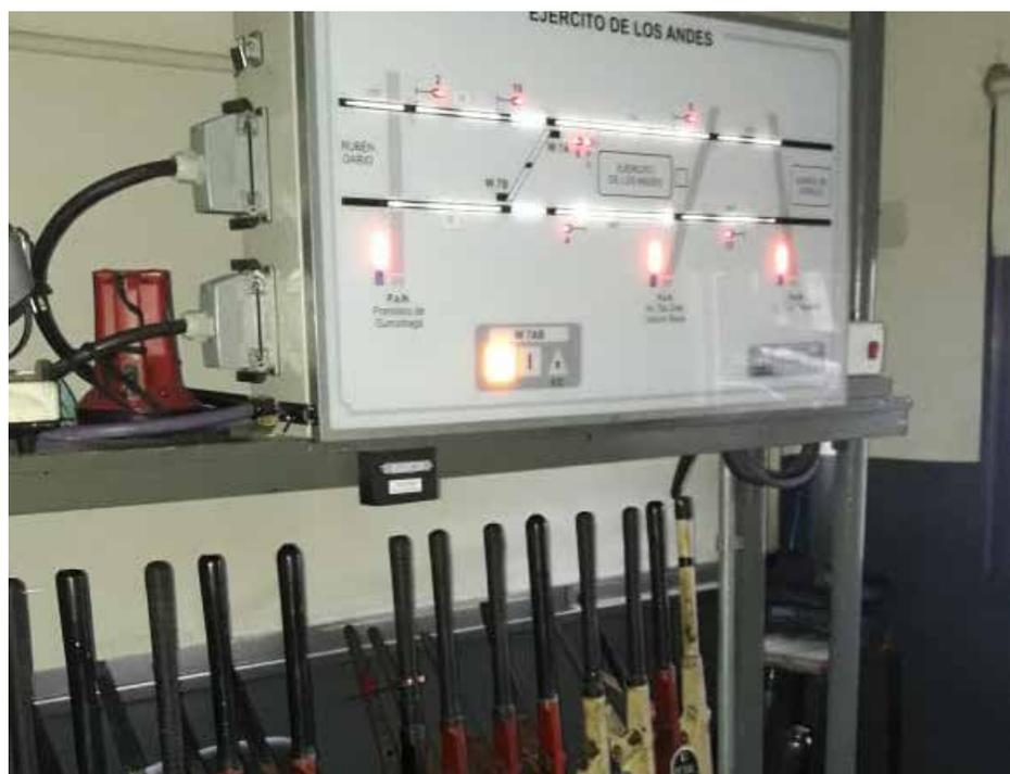
*Cabina mecánica - accionamiento manual de palancas.*
