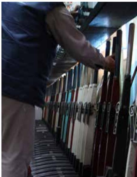
*Cabina mecánica que muestra las palancas en posición NORMAL, colocadas hacia atrás*
