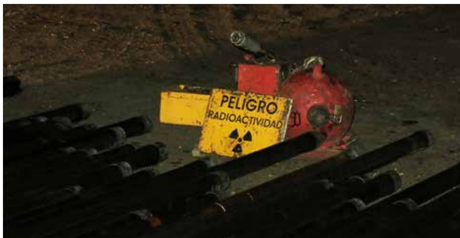
En la imagen vemos el portafuente, una telepínta y la caja para depositar residuos radiactivos junto al cartel indicador de peligro por presencia de radioactividad.
