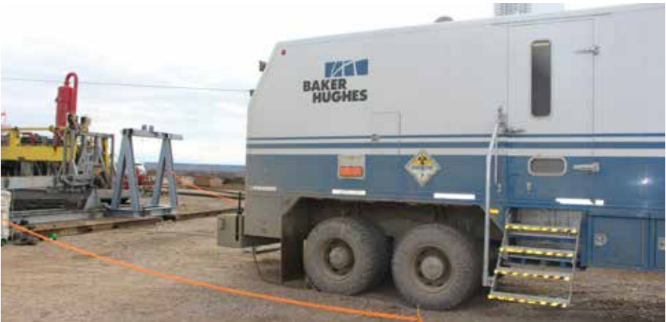
Demarcación de zona limitando la circulación. En esta maniobra se contempló el riesgo de rotura de cable asociado a riesgo radiológico en el tendido perimetral de cadenas.
