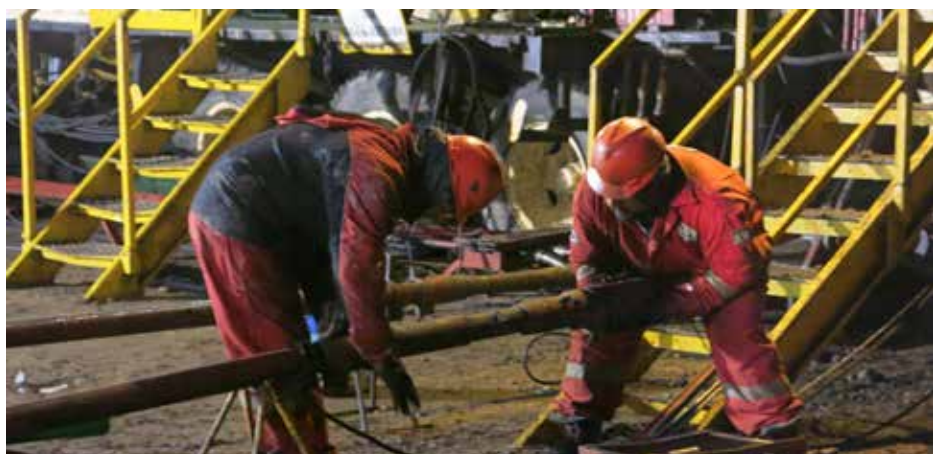
Armado conjunto de la herramienta de perfilaje, previo a la colocación de la fuente.
