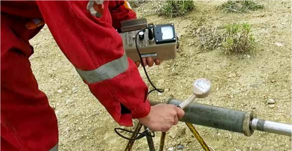
Proceso de monitoreo con un detector Geiger sobre un inyector.
