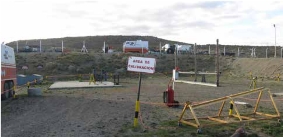
Demarcación y señalización de zona dedicada a la calibración de fuentes selladas, en el marco de la locación. Cuenta con dosimetría de área.
