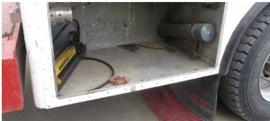
Otra vista de la estructura de una caja transportadora de porta fuente ubicada en la parte trasera inferior del chasis del camión, donde también suelen alojarse herramientas y elementos de protección personal para la manipulación de fuentes radiactivas.
