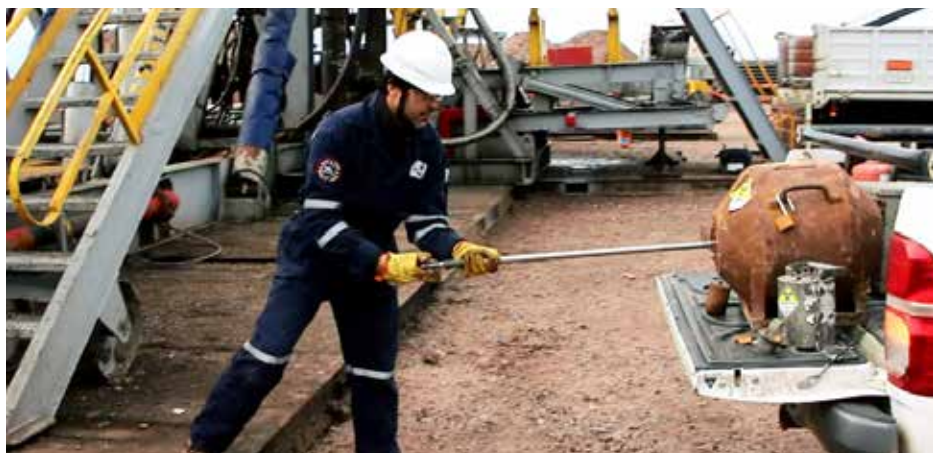
Maniobra correcta de manipulación de una fuente de neutrones con telepinza, previo a su traslado hacia el bunker de la base de operaciones.
