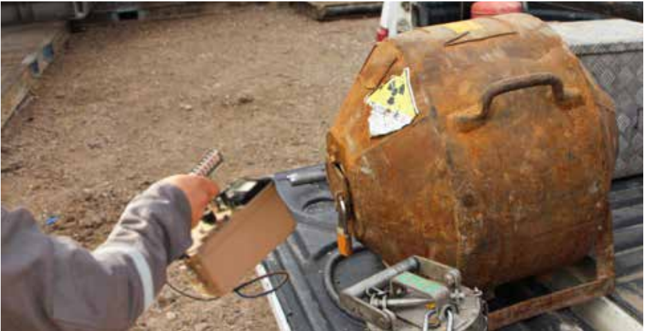
Monitoreo de niveles de radiación emitida por una bocha porta fuente, donde ya se ha almacenado una fuente de neutrones.
