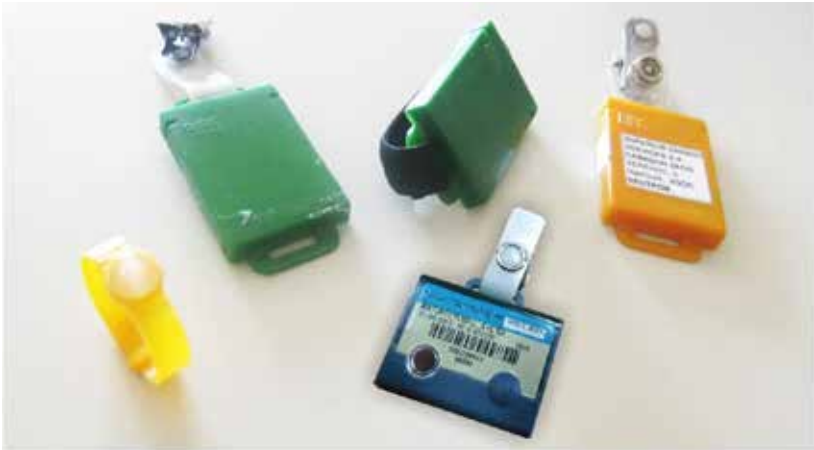
Variedad de dosímetros personales (TLD, OSL, de anillo) para detectar emisión radiactiva de distintos tipos de fuente y con distintas tecnologías de registro.
