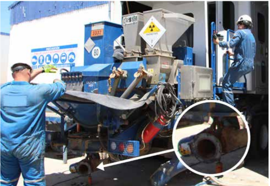
Tareas de mantenimiento de un camión de cementación equipado con densímetro, a cargo de trabajadores utilizando dosimetría personal y señalizado con la cartelería identificatoria de radiaciones correspondiente.
