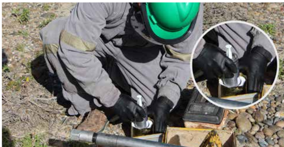
Maniobra de manipulación de IODO radiactivo con un porta jeringa plomado.
