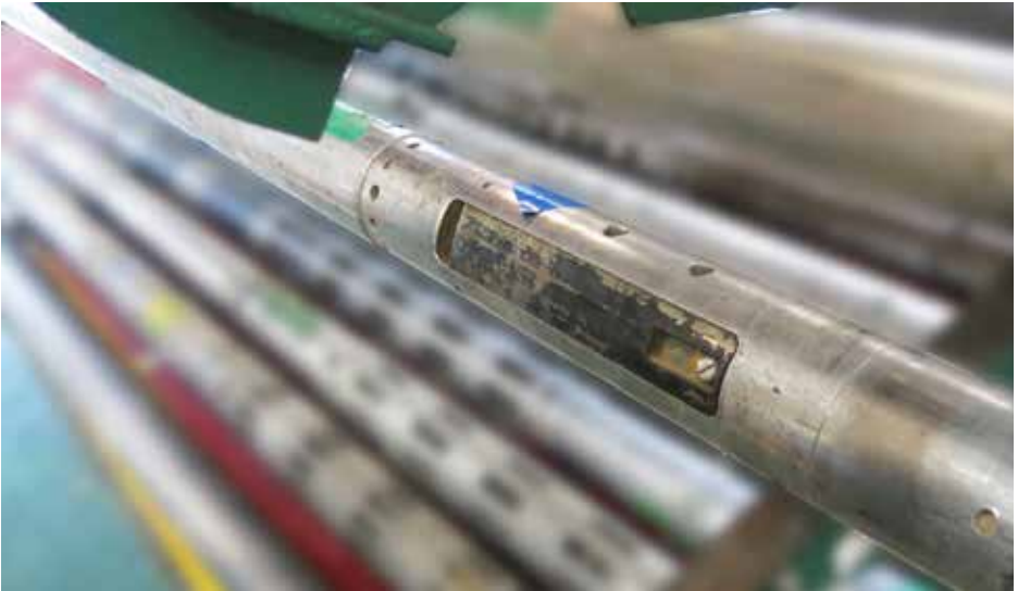
Sistema de seguridad de herramienta de Perfilaje para la protección de la fuente radiactiva.
