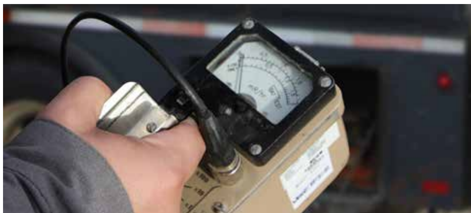
Monitoreo del nivel de radiaciones alrededor del camión de perfilaje, antes de iniciar la maniobra.
