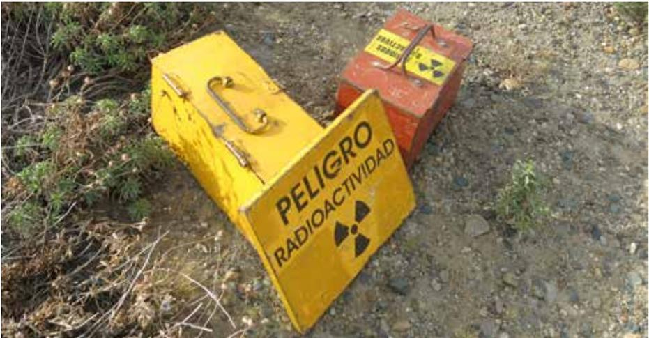
*Señalización del lugar en que se ubica la caja porta fuente y la de residuos radiactivos. Esto en el marco de una zona radio controlada designada por el equipo de operaciones especiales.*
