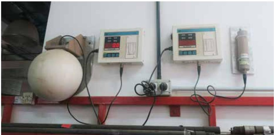
*Dosímetros de área monitoreando los niveles de radiación ambientales en un taller de almacenamiento y mantenimiento de herramientas.*
