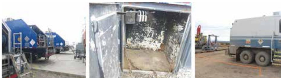
*Imagen 1: Camiones especiales para operaciones especiales con RI. Imagen 2: Baúl específico para traslado de material radiactivo. Imagen 3: Zona demarcada indicadora de presencia de RI durante la maniobra.*
