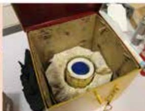
Posee material radiactivo contenido en frasco de vidrio, este a su vez dentro de un contenedor de plomo alojado en una lata. Todo este empaque dentro de una caja forrada internamente con telgopor. Con una actividad de XX Ci lo que supone una fuente de alta actividad. Recuerde siempre las normas para protegerse:
