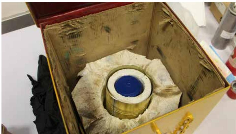
*El vial del trazador se encuentra alojado en un recipiente de plomo centrado en una lata con un anillo de telgopor para evitar golpes o desplazamientos. Luego un anillo de telgopor extra, embalaje de cartón y finalmente la caja Recipiente plomado, recubierto con cartón impermeable y con contenedor de telgopor. Todo ubicado en el cajón metálico de transporte.*
