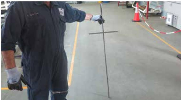
*Telepinza utilizada para la manipulación segura de fuentes radiactivas.*
