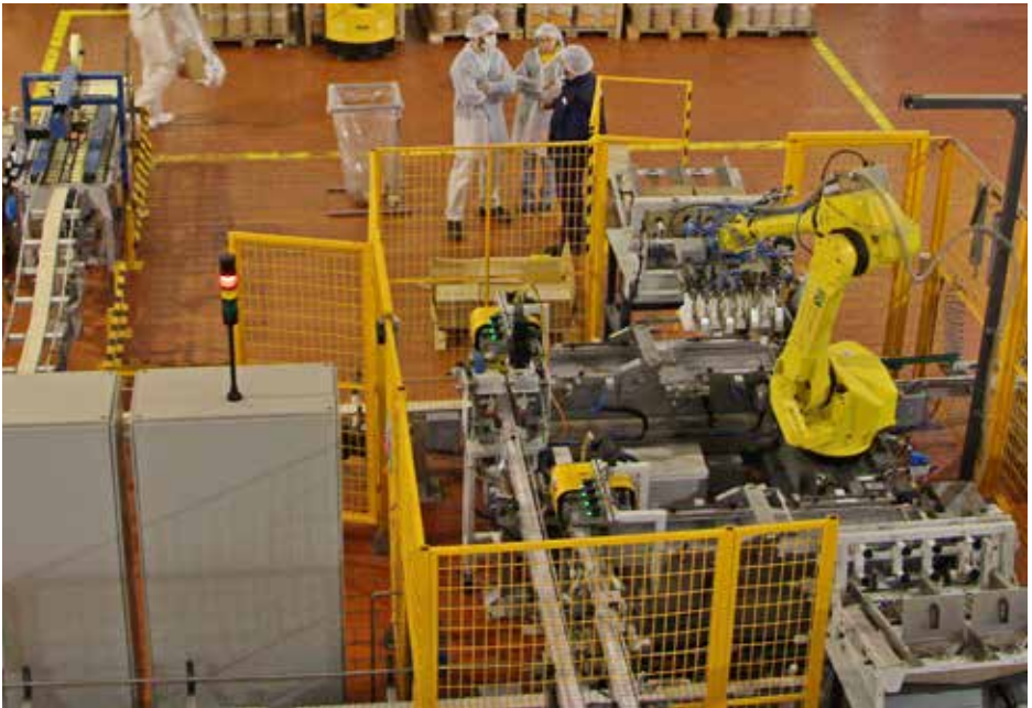
Sector de encajonado y palletizado.
