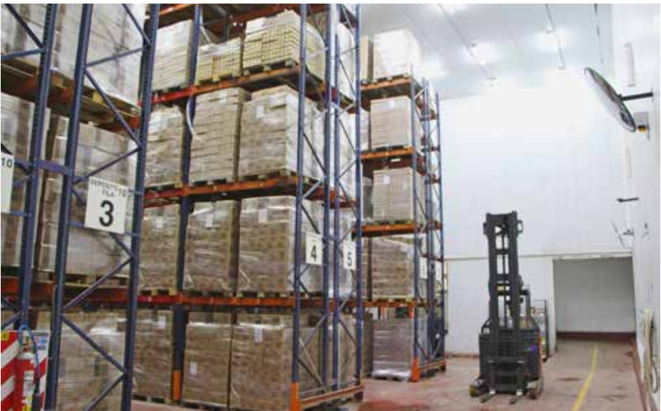
Autoelevador en cámara de frío.
