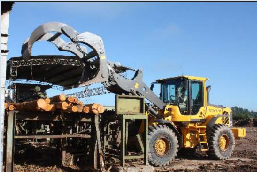
Traslado de rollizos desde la cancha de trozas hasta la zona de canteado, por intermedio de un tractor con pinzas.
