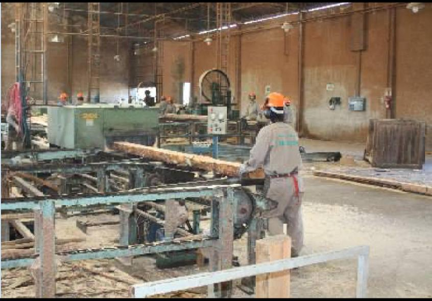
Tableadora con alimentación horizontal. El operario empuja el tronco en forma manual.
