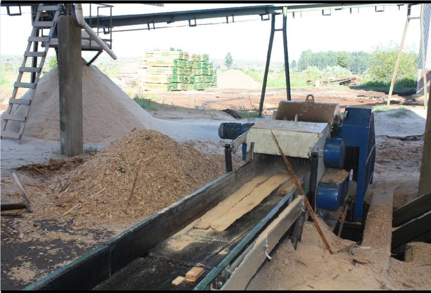
*Chipiadora con mesa mecanizada de desplazamiento de sobrantes. El trabajador monitorea a distancia este proceso*
