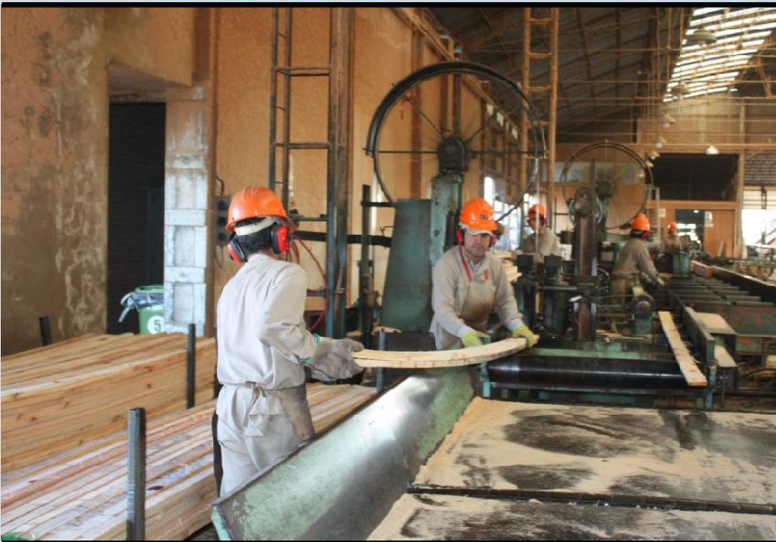
*Traslado de una tabla de madera hacia la mesa de despuntado. Como se ve el proceso se realiza entre dos trabajadores dado el largo y el peso del material transportado.*
