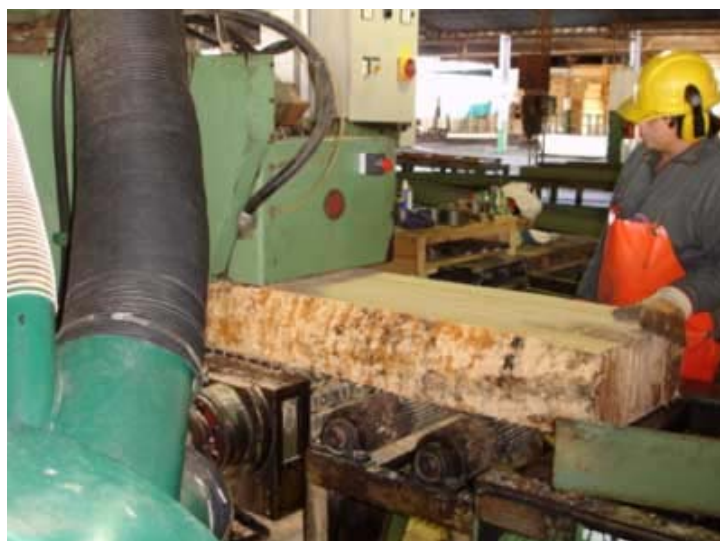
Foto N° 33: Salida del material cortado por sierra circular múltiple
