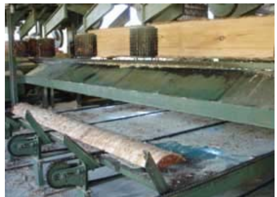
Fotos N° 29 y N° 30: Luego del corte se separan los costaneros del núcleo
