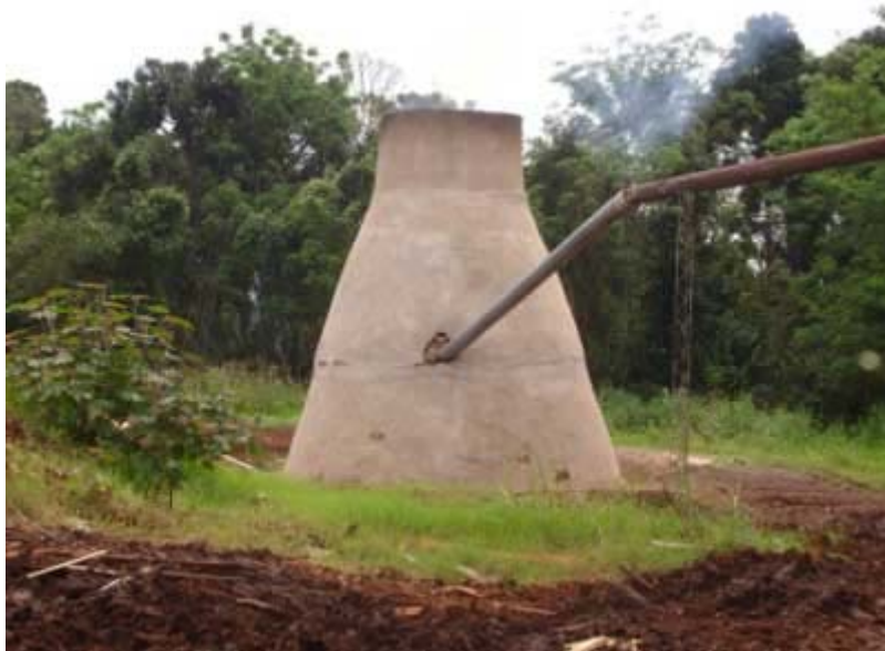
Foto N° 66: Horno para la quema de aserrín
