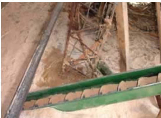
Fotos N° 48 y N° 49: Transporte de aserrín mediante un tornillo desde la fosa del volante inferior de la sierra sin fin
