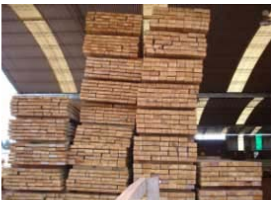
Foto N° 44: Material mal estibado
