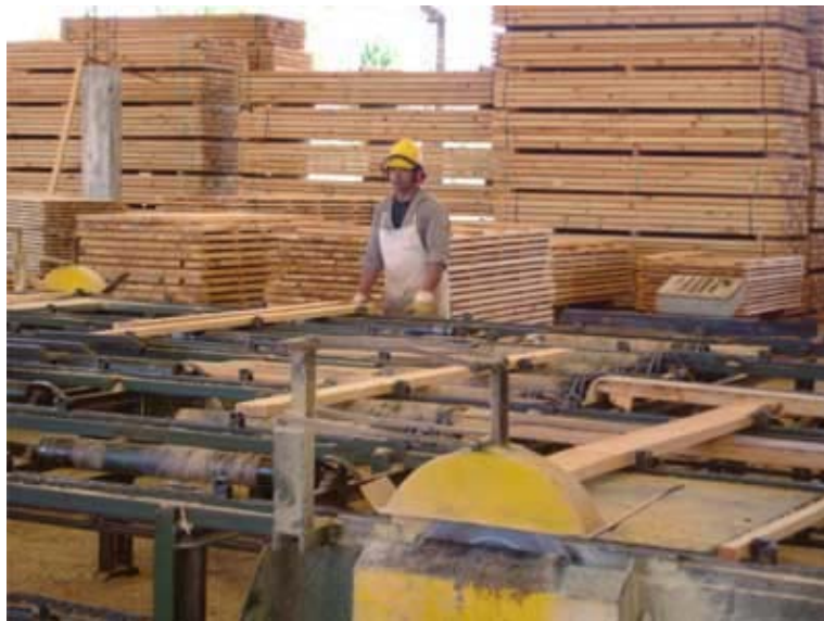
Foto N° 34: Despuntado en sierra circular
