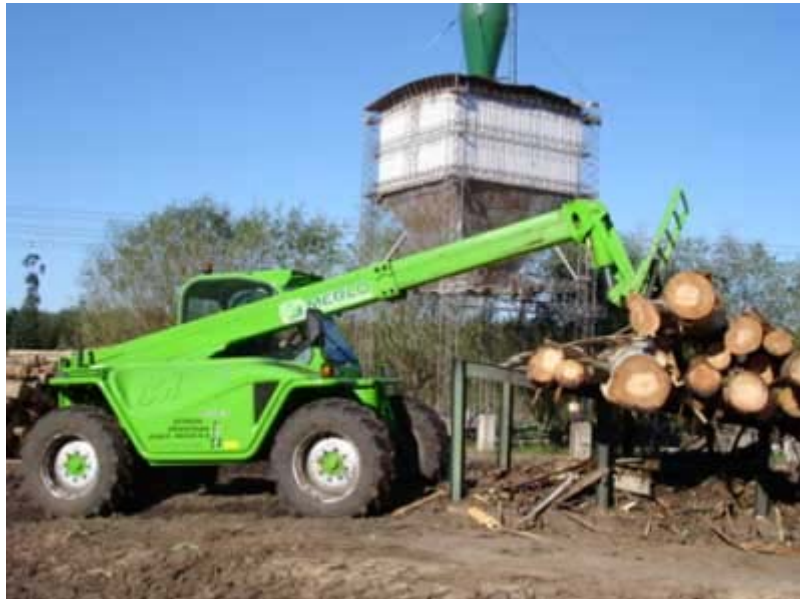
Foto N° 24: Transporte de troncos con vehículo de brazo telescópico con uñas
