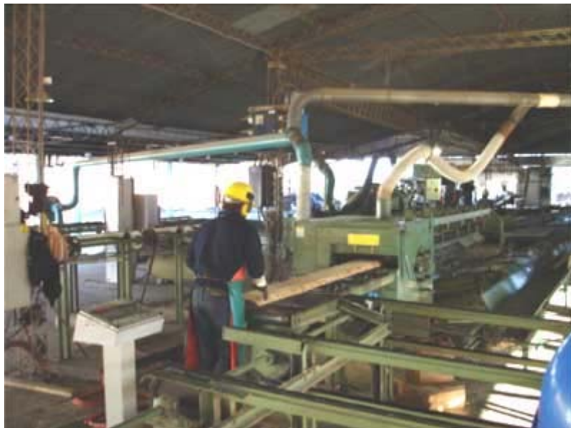
Foto N° 37: Alimentación de una sierra circular múltiple
