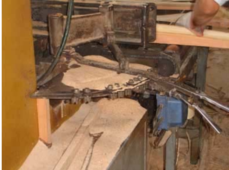
Foto N° 12: Sistema de regulación del corte
