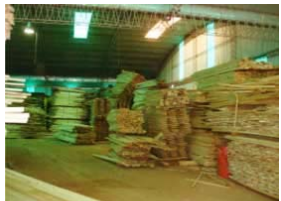
Foto N° 45: Material mal estibado
