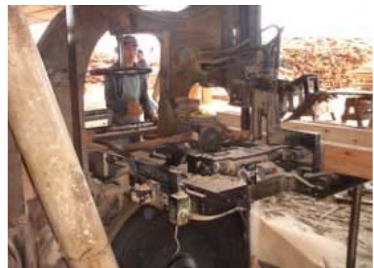
Foto N° 40: Hoja de sierra sin protección
