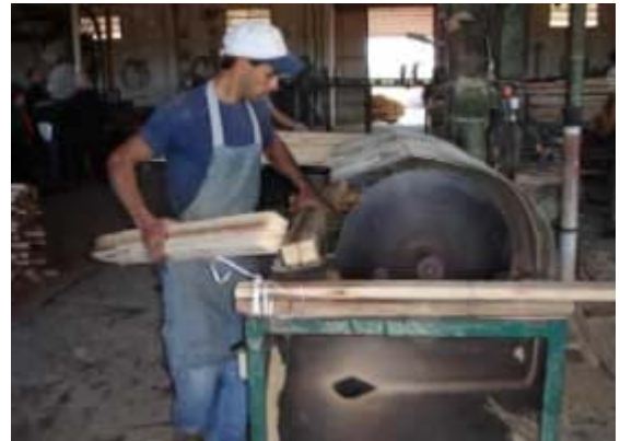
Foto N° 43: Sierra circular mal protegida
