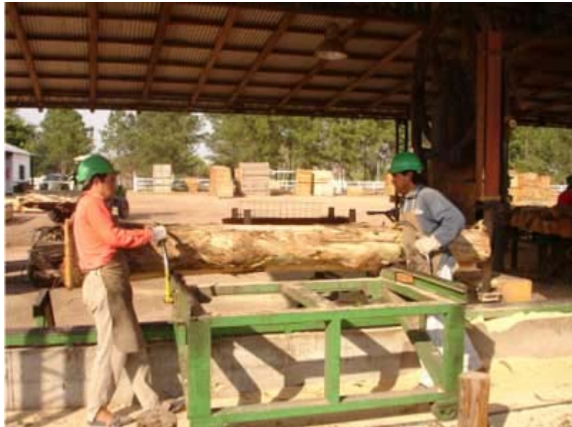
Foto N° 10: Sujeción del tronco con garras
