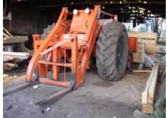
Foto N° 2: Tractor con uñas y garra
