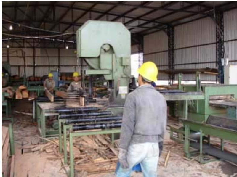
Foto N° 13: Tableadora con alimentación de rodillo vertical
