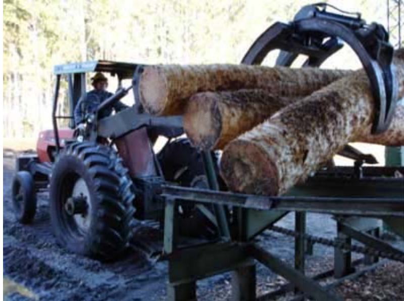
Foto N° 25: Transporte de troncos descortezados con tractor con garras
