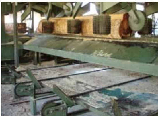
Fotos N° 29 y N° 30: Luego del corte se separan los costaneros del núcleo
