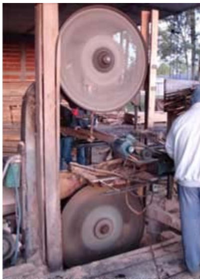
Foto N° 39: Protecciones faltantes y precarias
