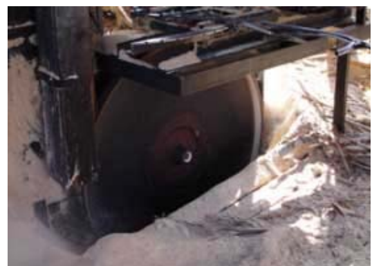
Foto N° 41: Volante sin protección
