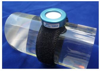
**Figure 1**. VioSpor<sup>(R)</sup> Blueline Type II UV dosimeter. Photo owned by Dr Hans Holtschmidt, BioSense Labor für Biologische Sensorik.
