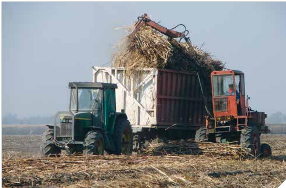
Figura 5. Cosecha semi-mecánica, cargadora mecánica
