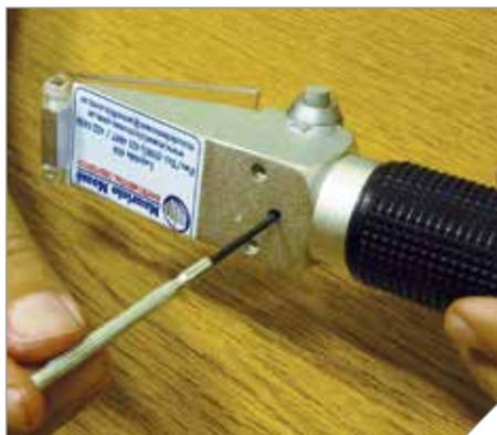
Figura 7. Tornillo para calibrar el refractómetro.
