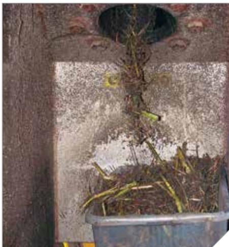
Figura 11. Muestra de caña después del desfibrado.
