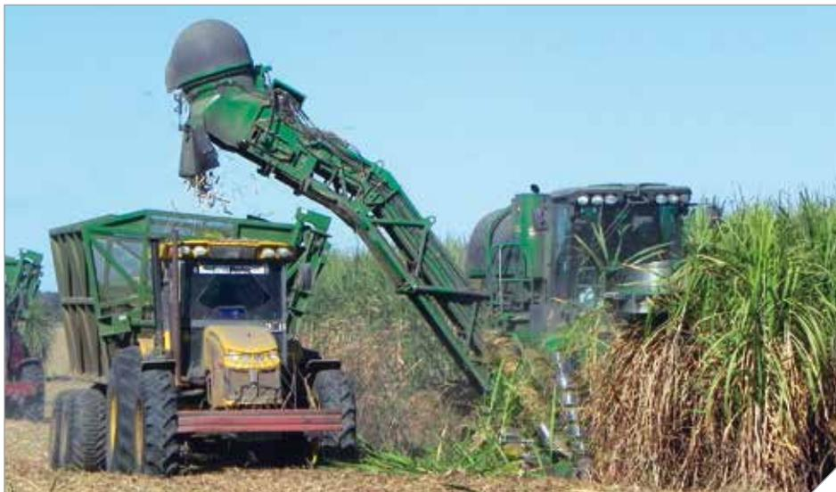
Figura 2. Cosecha integral con sistema de carga con autovuelcos.
