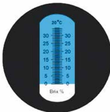
Figura 6. Imagen del campo del refractómetro con agua destilada.
