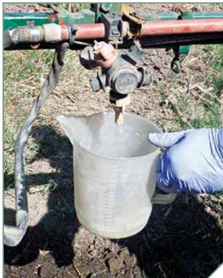
Figura 12. Cálculo de la descarga (l/m).
