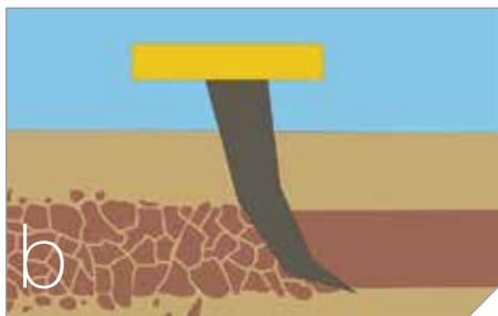
Figura 1. Esquema de la acción del cincel (a) y el subsolador (b) fracturando capas compactadas de suelo.
