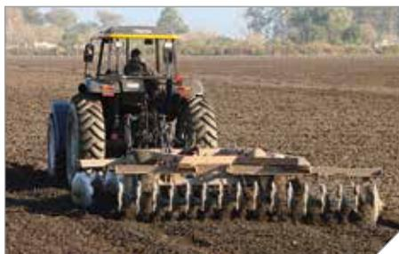
Figura 3. La rastra en la preparación de suelo para la plantación de caña de azúcar.
