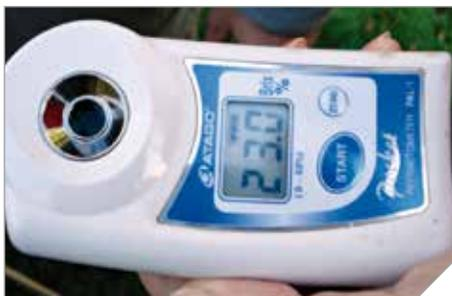
Figura 2. Refractómetros o Brixómetros de mano para medir el Brix en el campo.
