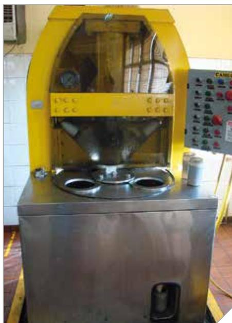
Figura 12. Prensa hidráulica para separar el jugo del residuo sólido.
