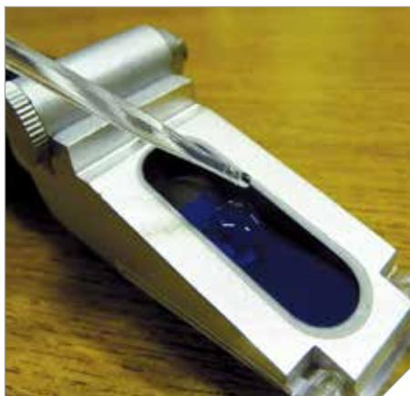
Figura 3. Calibración del refractómetro con agua destilada.
