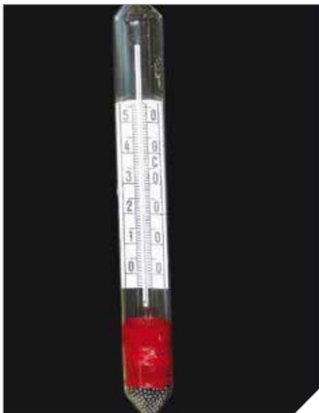
Figura 1. Brixómetro (densímetro).
