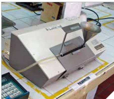
Figura 9. Polarímetro digital.
