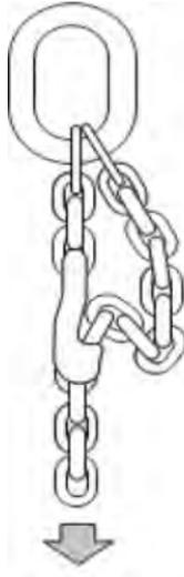
elemento adecuado, por ejemplo un gancho acortador de cadena (figura 66); en ningún caso debería efectuarse el acortamiento por medio de nudos en la eslinga.
