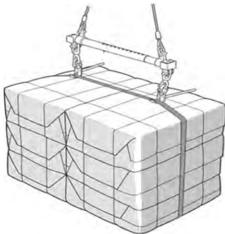
146. Cuando se ice una carga pesada o voluminosa, debería evitarse pasar un número excesivo de eslingas por el gancho.
