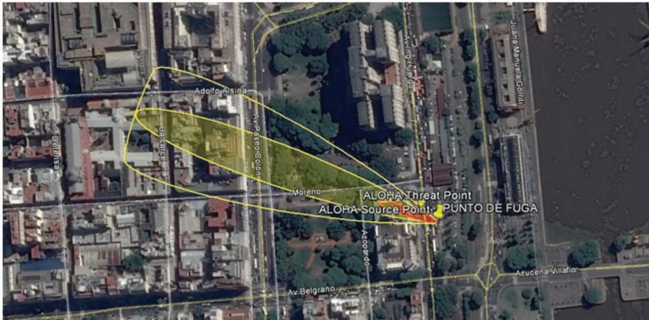
Para finalizar, se presenta otra aplicación de ALOHA, la simulación de una zona de afectación en torno al punto donde se ha producido una BLEVE.
