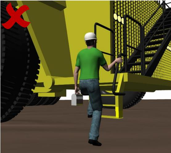
**El problema:** Un conductor que se sube a una escalera de mano o escalerilla de acceso cuando ingresa a maquinaria móvil y lleva una lonchera no puede mantener los tres puntos de contacto de manera segura.
