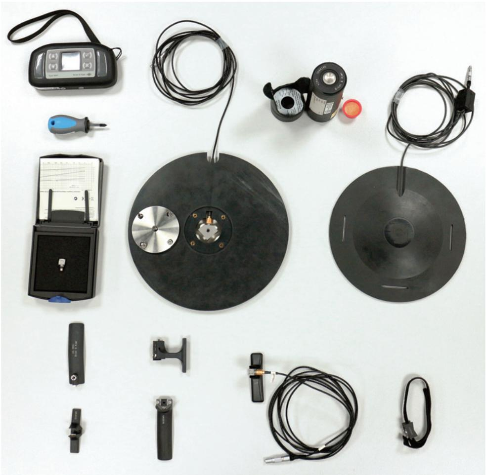
**Figura 7:** ejemplo de vibrómetro con sus accesorios
