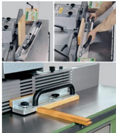
Figura 112. Ejemplos de aplicación de los dispositivos de sujeción.
