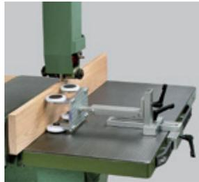
Figura 110. Serrado de una pieza con rodillos de guía.
