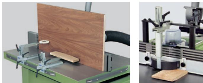
Figura 113. Sistemas de presión, rodillos y patines en diferentes aplicaciones.
