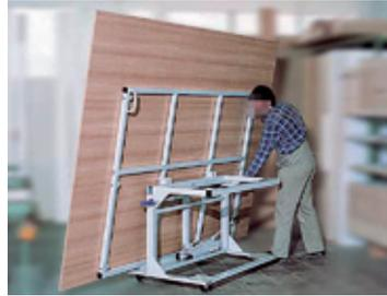
Figura 74. Carro de transporte de tableros.
