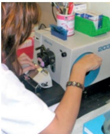
*Figura 3. Activación de la manilla para realizar el corte.*
