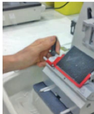
*Figura 5. Palanca para realizar el desplazamiento de la base donde está ubicada la cuchilla.*
