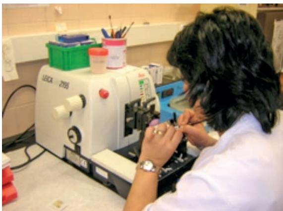
Figura 1. Pinza con la mano de sujeción del corte con la muestra y la parafina.
