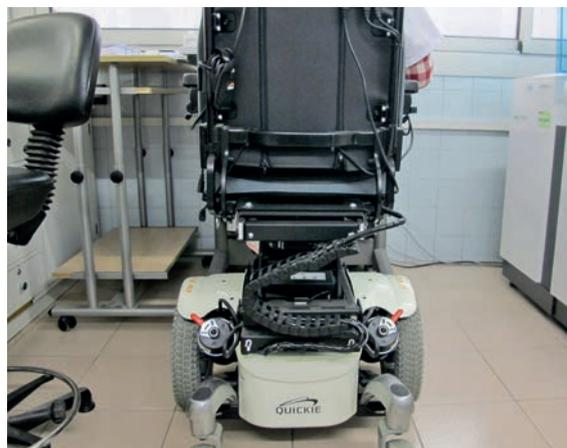
*Figura 8. Modelo de silla regulable en altura.*
