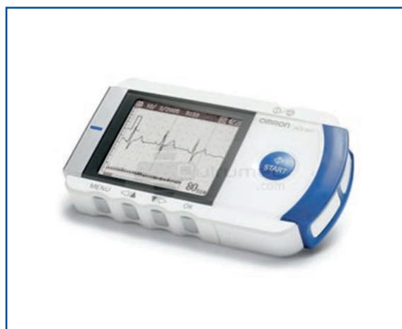
Figura 9. Electrocardiógrafo portátil.
