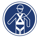
Protección individual obligatoria contra caídas
