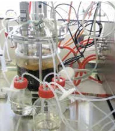
Figura 1. Biorreactor de tanque agitado, con 3 litros de medio de cultivo que contiene vinaza/glicerol.
