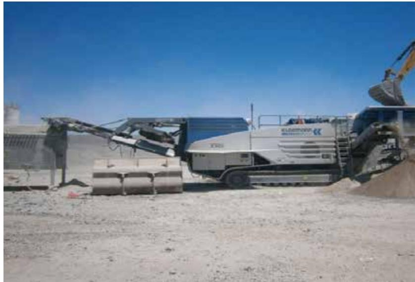
Figura 1. Planta trituradora y clasificadora de hormigón.
