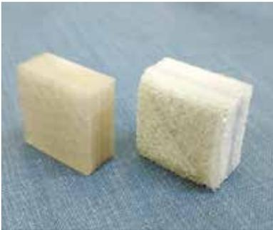
Figura 1. Cubo de prueba de PETpc con y sin secado.
