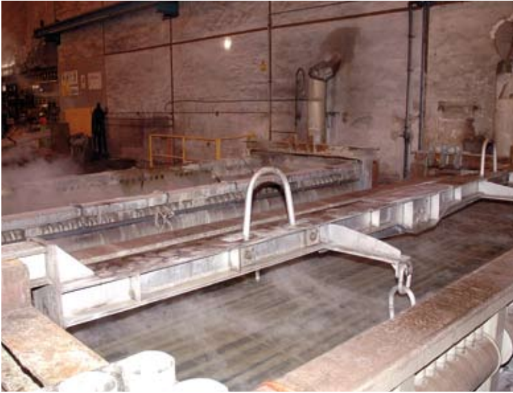
Línea de decapado químico
