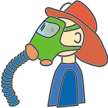
**La máscara con manga y ventilador:** es un aparato que consiste en una careta, perfectamente adherida a la cara, que cubre ojos, nariz y boca, unida a un tubo de gran diámetro y de paredes muy resistentes. Por el otro extremo, el tubo está unido a un ventilador que es movido a mano o mecánicamente, y que suministra aire respirable al usuario.
