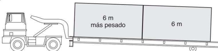
Figura 88. Remolque de plataforma baja atravesando una rampa
