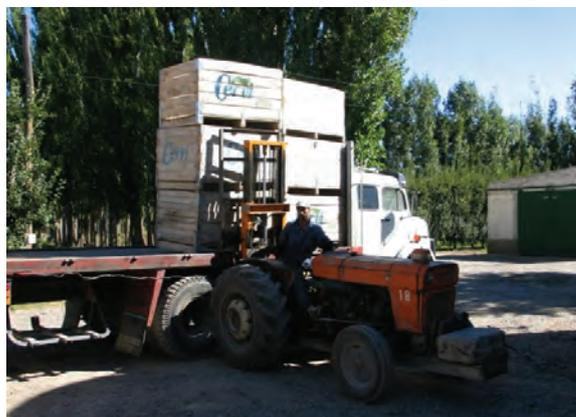
**Figura 43:** Un tractor provisto con elevador en su levante de tres puntos llamado tracto-elevador. Es seguro y fácil de operar para levantar bines y efectuar movimientos a cortas distancias.
