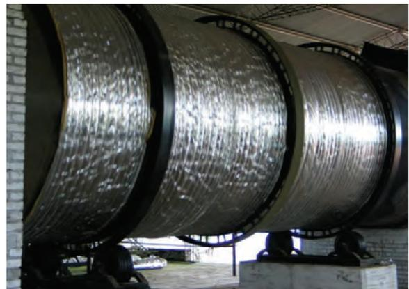
Figura 4: Tambor del horno de zapeado de yerba mate recubierto con aislamiento térmico. De esta forma el rendimiento energético es mayor obteniéndose más kilos de producción al mismo costo energético.
