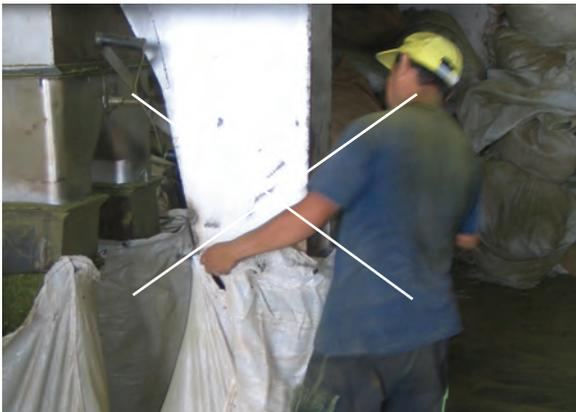
**Figura 2:** Las tareas de embolsado de yerba mate canchada requieren la instalación de un sistema de extracción de polvo. Como último recurso provea máscaras apropiadas y renuévelas todos los días.
