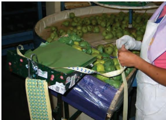
Figura 6: Las etiquetas y otros elementos menores utilizados en el proceso de trabajo deben ubicarse cerca del puesto y al alcance del trabajador para lograr tareas más productivas.
