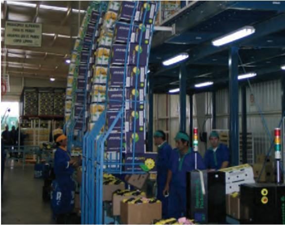
**Figura 8:** Disposición de un sistema de alimentación de envases en dos niveles. La línea de envasado está ubicada en una planta a nivel del piso. La alimentación de los cajones baja desde un entrespacio superior mediante unas guías que los dejan a mano para ser utilizados.
