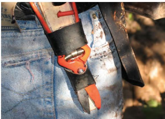
Figura 5: Herramienta de uso frecuente en un dispositivo con fácil y rápido acceso para el trabajador. Antes de guardarla es conveniente colocar el seguro que la mantiene cerrada para evitar que los filos expuestos dañen al trabajador.
