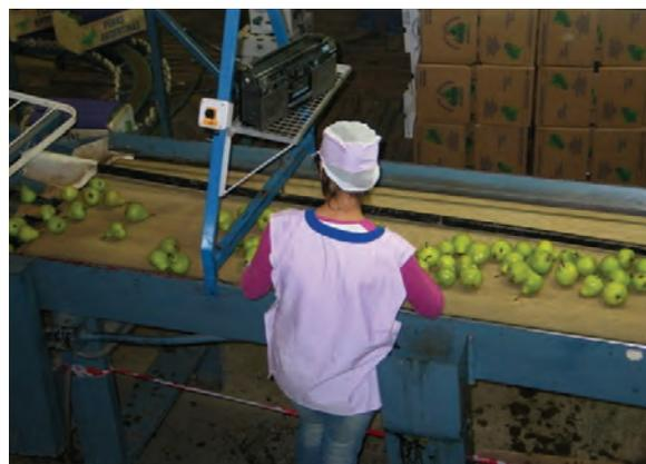
Figura 30: El interruptor de la marcha de la línea de producción está al alcance de la mano de la operadora y es fácilmente reconocible.
