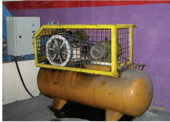
Figura 6: Protección de bajo costo fabricada por trabajadores de la empresa para cubrir las correas en un compresor.
