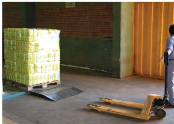
Figura 23: Las cargas en tarimas se pueden mover con la ayuda de equipos especiales, tales como esta zorra, sin ningún tipo de esfuerzo físico extra
