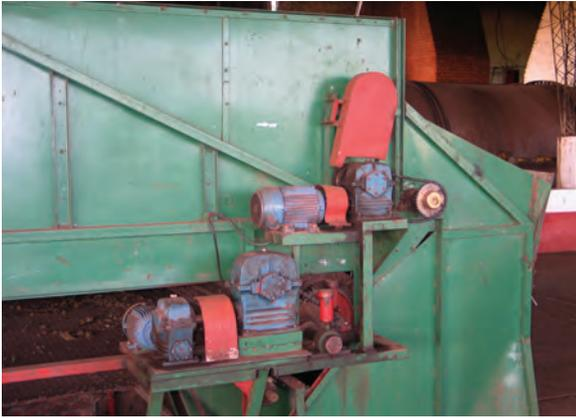
Figura 5: Protecciones de bajo costo realizadas en chapa que cubren las partes móviles de una cinta transportadora.
