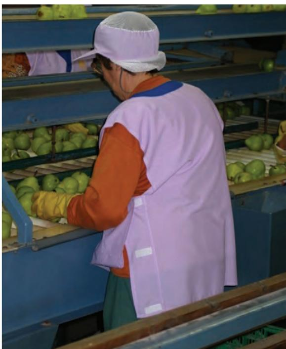
Figura 14: Este puesto de trabajo destinado a la clasificación de distintas calidades de peras cuenta con cintas transportadoras ubicadas en tres niveles. Los tres niveles deben permitir operaciones cómodas para las trabajadoras.
