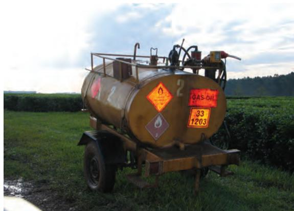
**Figura 1: Los tanques o depósitos que contienen sustancias peligrosas deben estar correctamente señalizados.**
