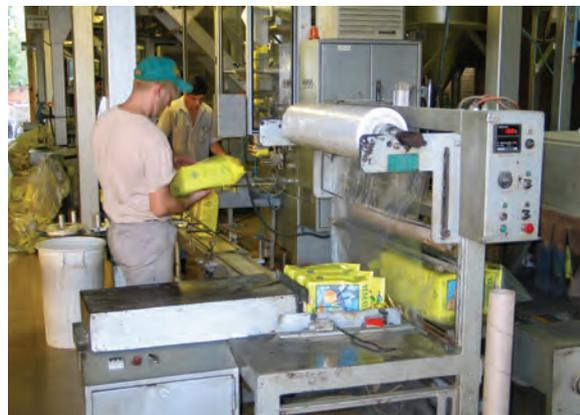
Figura 8: Equipo de envasado semiautomático provisto de fábrica con elementos de seguridad según normas internacionales.
