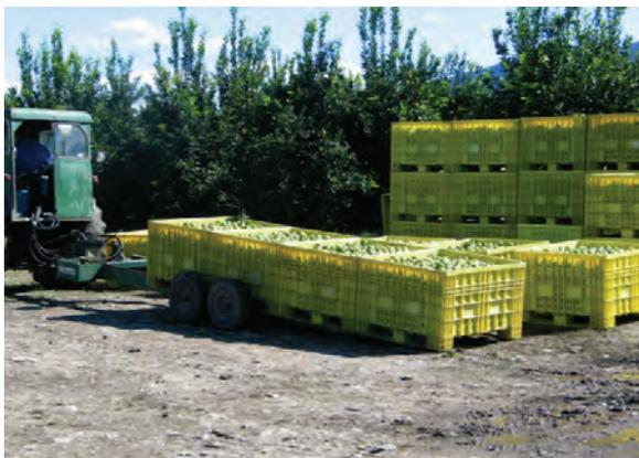
Figura 4: El transporte de grandes contenedores puede mejorarse mediante un chasis bajo que es arrastrado por un tractor. Así se incrementa la productividad en el movimiento de materiales.
