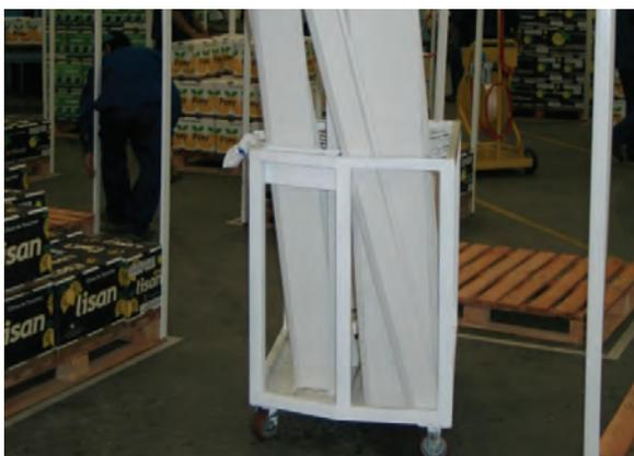
**Figura 29:** Contenedor con ruedas que permite almacenar y transportar con facilidad los elementos utilizados en el proceso productivo. En este caso se trata de guías de plástico para el armado de pallets de cajas de frutas y que rigidizan el conjunto armado.
