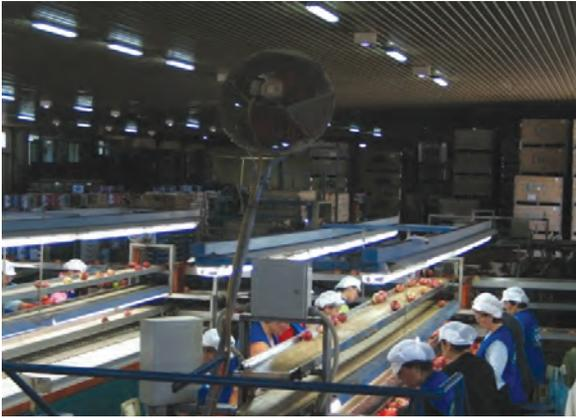
Figura 5: Ejemplo de ventilador industrial amurado a una estructura y orientado hacia los trabajadores de la línea de producción.
