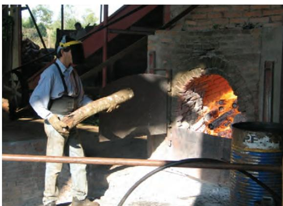
**Figura 14.** La carga manual de hornos a leña requiere la provisión de guantes, calzado especial y una máscara que proteja a los ojos de las radiaciones.
