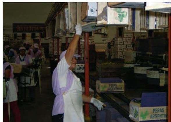
Figura 3: Transportador aéreo de cajones. La velocidad de avance de la cadena marca el ritmo de producción y la forma en la que se abastece a la línea según el tipo o calidad de producto.
