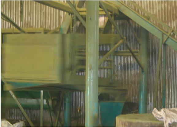
Figura 2: El polvo en suspensión en el aire puede afectar la salud de los trabajadores. Cuando cae, cubre máquinas, equipos y otros elementos pudiendo causar roturas y desgastes prematuros.
