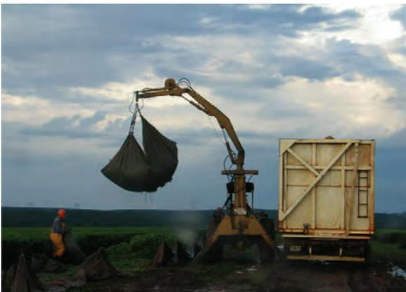
**Figura 45:** Los fardos pesados y voluminosos pueden ser fácilmente manipulados y cargados usando equipos especiales de izaje y manipulación.
