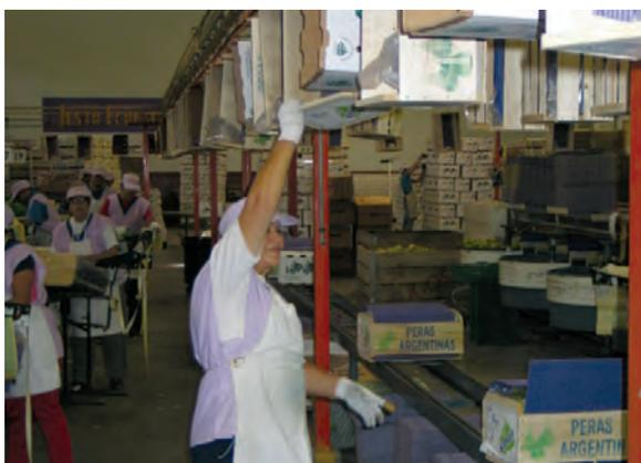
**Figura 6.** Línea de envasado alimentada con un sistema aéreo de aprovisionamiento de cajas de cartón para el envasado de frutas. ¿Qué piensa usted acerca de la altura a que se encuentra el sistema?
