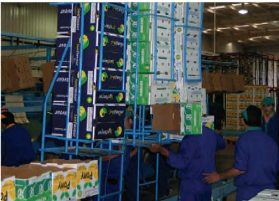
**Figura 19: Sistema de alimentación por gravedad utilizado para abastecer a la línea de producción con cajas para embalaje de frutas.**
