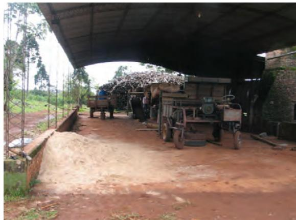
Figura 1: El piso obstruido impide el flujo fácil de material y de trabajadores, ocasionando demoras, errores y accidentes en la producción.
