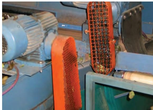
Figura 7: Dos guardas de bajo costo integradas a la estructura de la máquina cubren las correas del equipo resguardando al trabajador de posibles contactos accidentales.
