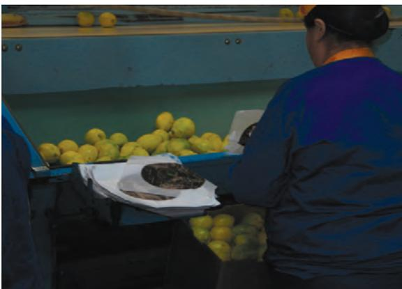
**Figura 10:** Puesto de trabajo ergonómicamente correcto y con los materiales al alcance de la mano.
