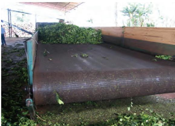
Figura 8: La velocidad de avance de la cinta es un factor importante de productividad de todo el sistema de secado en el sector de la yerba mate. Sin embargo, está limitada por la capacidad horaria del secado de los hornos.
