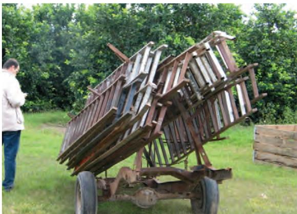
**Figura 28:** Equipo utilizado para transportar escaleras hasta los lugares de trabajo.
