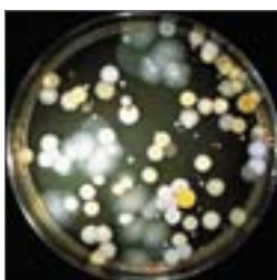
Moho en un filtro de aire de escape (Berufsgenossenschaftliches [BG] Institut für Arbeitsschutz, Alemania).
