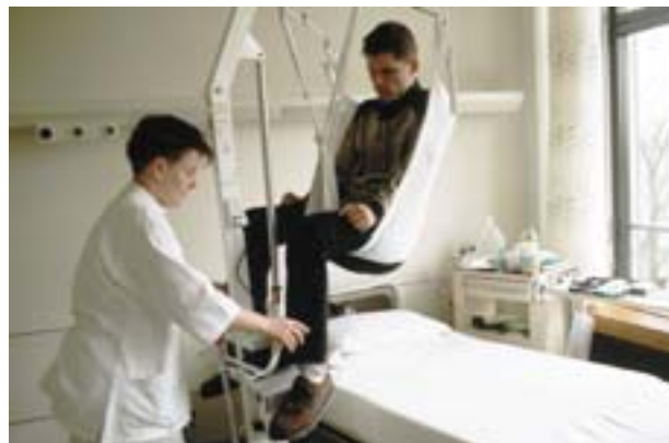
Elevador para el manejo de personas en el sector sanitario (Berufsgenossenschaftliches [BG] Institut für Arbeitsschutz, Alemania).
