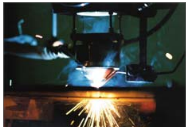
Tratamiento de materiales con rayo láser que da lugar a la creación de partículas ultrafinas, (Berufsgenossenschaftliches [BG] Institut für Arbeitsschutz, Alemania).
