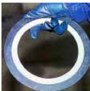
Junta de amianto.
