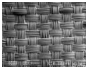
Ampliación x50 de una costura recubierta Tyvek-Pro. Tech® Classic Plus
