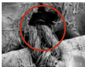
Ampliación x50 de una costura cosida Tyvek-Pro. Tech® Classic
