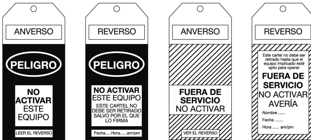
Figura 7. Ejemplos de carteles que pueden colocarse sobre los dispositivos de maniobra para prohibir su accionamiento
