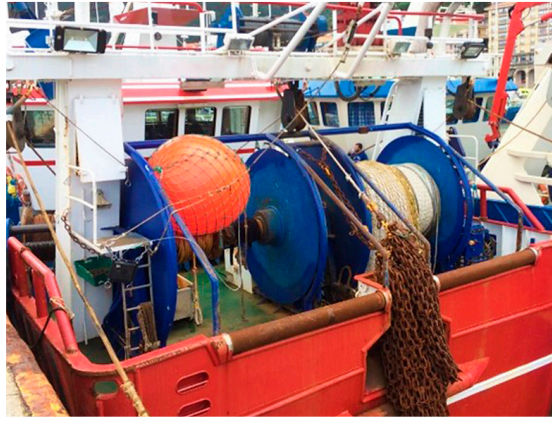
Figura 8. Carreteles a popa con estructuras tubulares en los bordes de las guardas.
