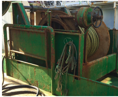
Figura 13. Maquinilla de arrastre hidráulica con embrague y freno de banda de accionamiento neumático y manual.
