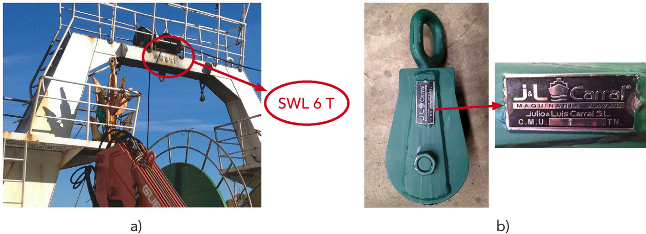
Figura 17. a) Palo bípode de popa con marcado de la carga de trabajo segura de 6 toneladas y b) Pasteca de maniobra con placa de características indicando el nombre del fabricante y la carga máxima de utilización de 1 tonelada. Fuente consultada en 2018: https://jlcarral.es/ . Julio & Luis Carral S.L.
