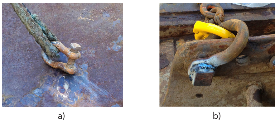
Figura 25. a) Grillete reparado con aporte de material. b) Grillete con bulón soldado.
