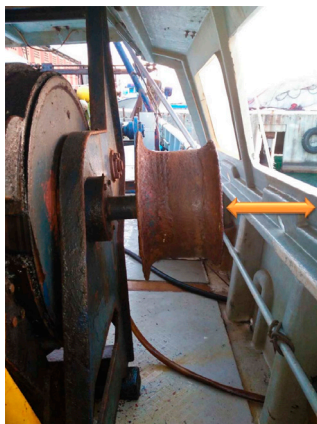
Figura 19. Maquinilla monobloque con cabirón invadiendo el pasillo (espacio de paso 40 cm). Fuente consultada en 2024: Informe CIAIM-08/2016. Comisión Permanente de Investigación de Accidentes e Incidentes Marítimos.
