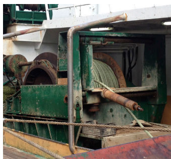
Figura 10. Estibador con un rodillo desmontado y plataforma de acceso.
