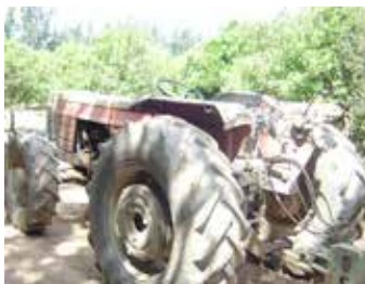
Tractor sin protección para el operador
