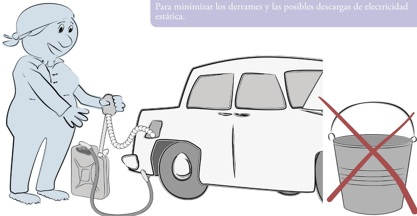
Use cintas de conexión de toma de tierra entre el chasis del vehículo y el contenedor.
