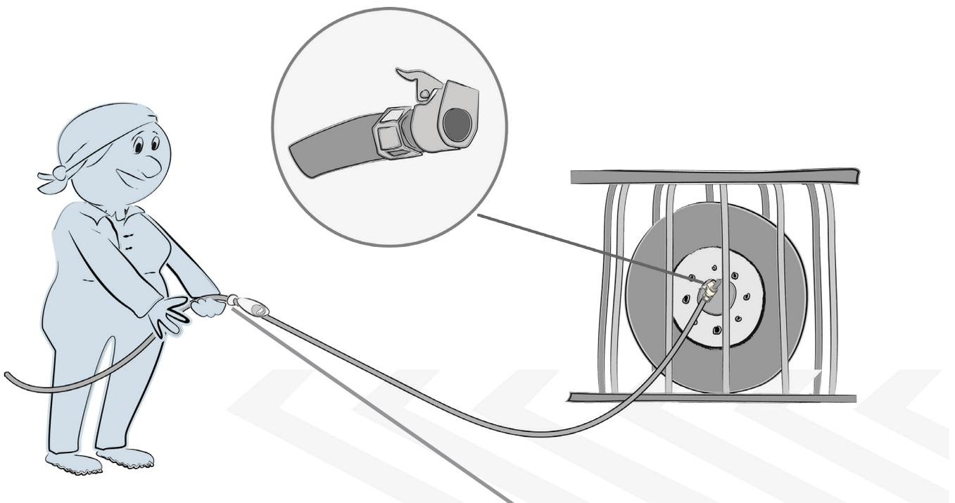
Infle los neumáticos comerciales dentro de una jaula, anclados al suelo o en otros dispositivos de retención.
