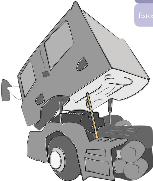
*Cuando trabaje con remolques inclinados o cabinas de vehículos, debe garantizar que coloca soportes adicionales para prevenir que el remolque o la cabina se caigan y aplasten a los trabajadores. Los amortiguadores no necesariamente pueden soportar la carga mientras se trabaja debajo.*
