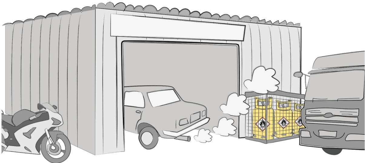
Si tiene que mantener el motor encendido, minimice el tiempo de funcionamiento y conecte los equipos de extracción al tubo de escape de los vehículos.
