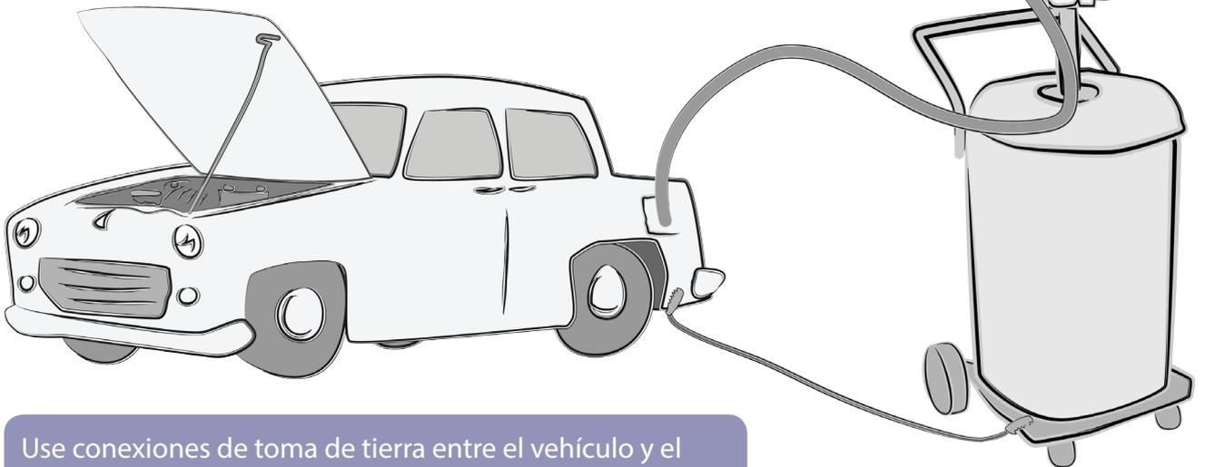
Use conexiones de toma de tierra entre el vehículo y el recuperador de combustible.
