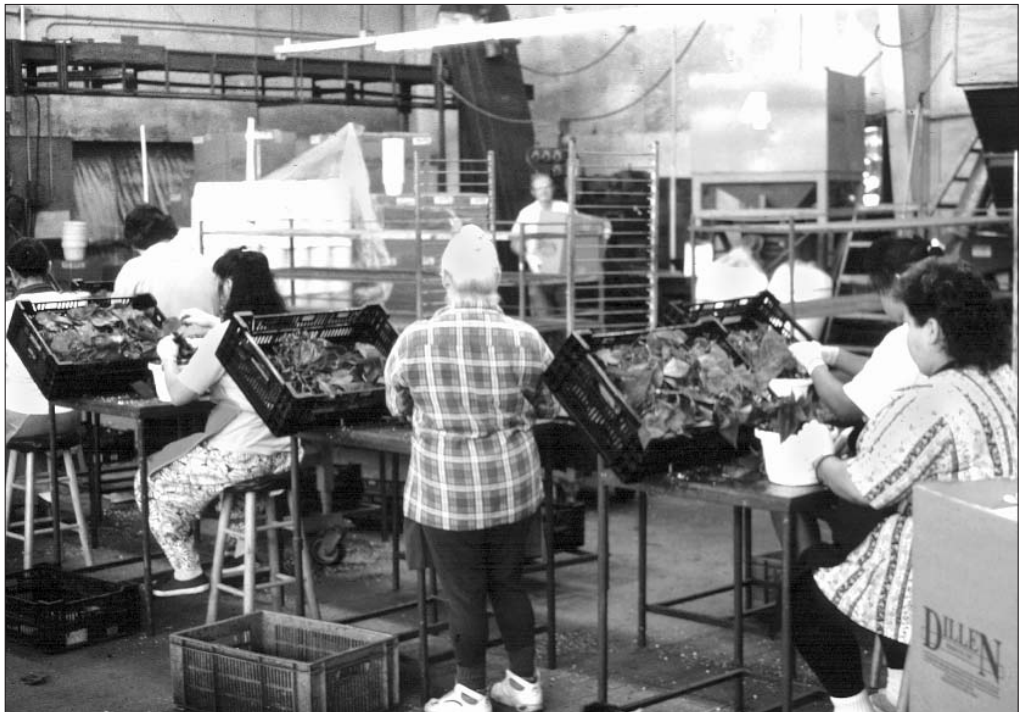
Estaciones de trabajo recién diseñadas para enmacetar plantas. Las estaciones de trabajo tienen bandejas o cajas con plantas en posiciones inclinadas. Al colocarlas de esta forma, la gravedad hace que las plantas se deslicen hacia abajo, quedando más cerca del trabajador. Se reduce así la necesidad de que el trabajador tenga que estirarse para alcanzar las plantas.
