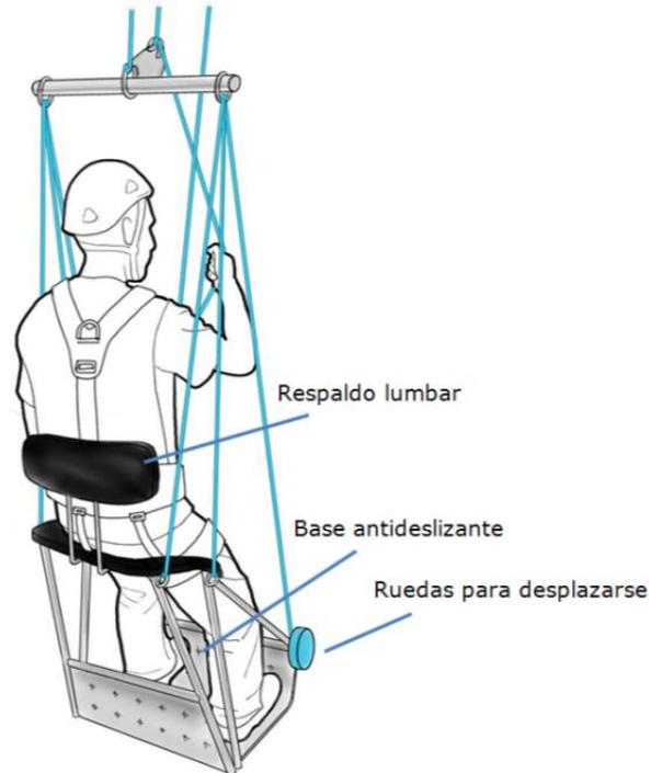
Figura 34. Imagen diseño semisentado, vista trasera-lateral.
