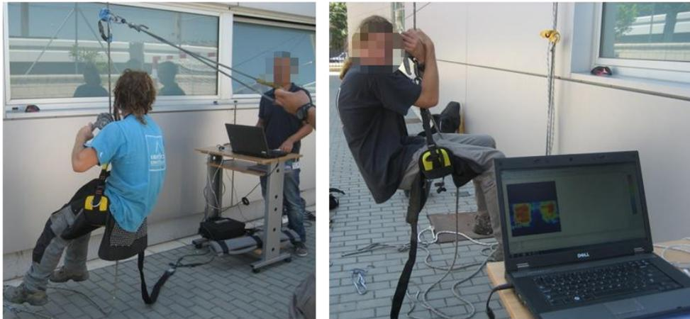
Figura 17. Montaje para la medida mediante manta de presiones.
