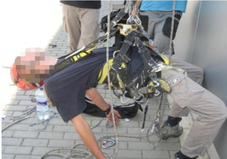
Figura 2. Simulación posición estado inconsciente.
