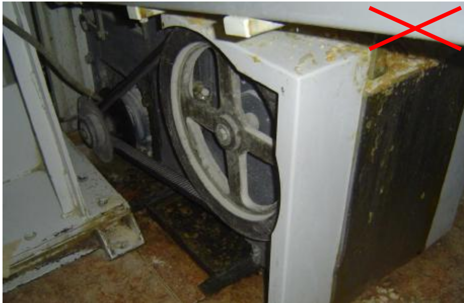
Mecanismo de transmisión correa-poleas sin resguardo protector
