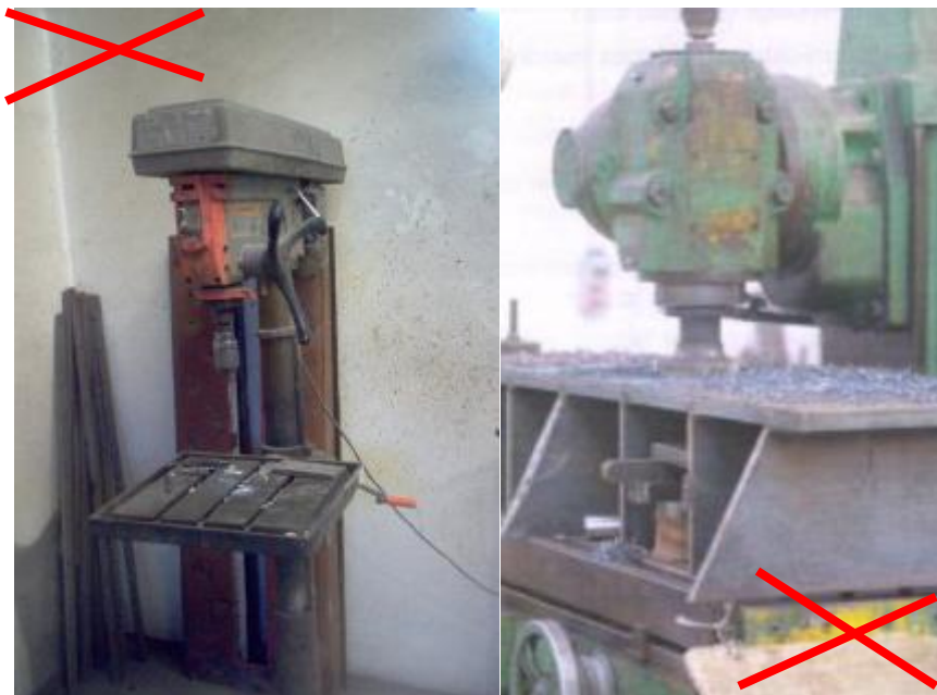
Herramientas (fresa y broca) sin protección
