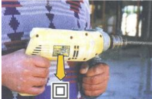
Taladro portátil con doble aislamiento
