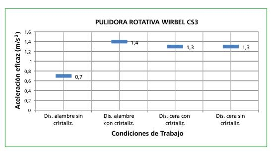
**Gráfica 29.** Comparativa: Disco alambre sin cristal. Vs Disco alambre con cristal. Vs Disco cera sin cristal. Vs Disco cera con cristal
