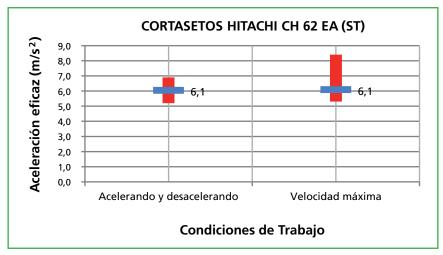
Gráfica 15. Comparativa: Acelerando y desacelerando Vs velocidad máxima
