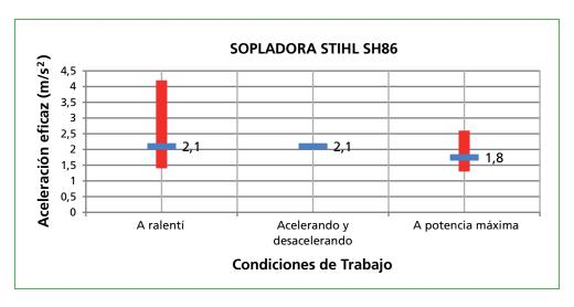
**Gráfica 24.** Sopladora STIHL SH86 – Comparativa: Ralentí Vs Aceler./desaceler. Vs Velocidad máxima
