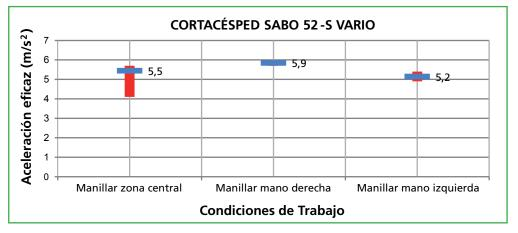
Gráfica 2. Comparativa: Acelerómetro en diferentes puntos del manillar
