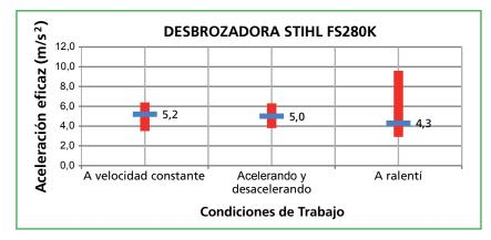
Gráfica 11. Comparativa: A velocidad constante Vs acelerando y desacelerando Vs ralentí
