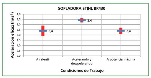
**Gráfica 27.** Sopladora STIHL BR430 - Comparativa: Ralentí Vs Aceler./desaceler. Vs Velocidad máxima
