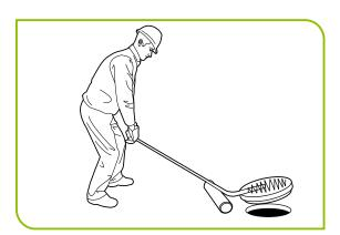
Figura 27, Levanta y mueve tapas de alcantarillas.
