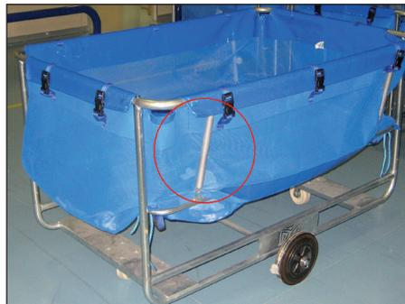
El muelle de los carros con fondo móvil permite elevar el fondo del carro a medida que éste se va vaciando para evitar tener que flexionar el tronco y extender los brazos para coger la ropa que queda en el fondo.
