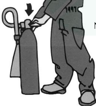
2. SUJETAR EL MANGO CON UNA MANO Y CON LA OTRA APRETAR HACIA ARRIBA, ORIENTANDO EL CHORRO HACIA LA BASE DE LAS LLAMAS
