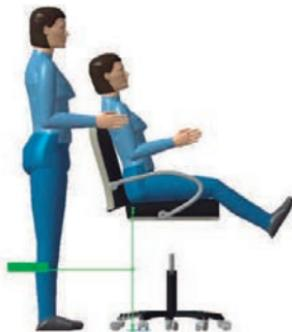
**Ilustración 49. Percentil 95 de técnico y percentil 5 de cliente con regulación a la altura de los codos flexionados en la zona media de la espalda de la cliente**
