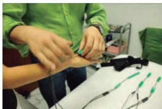
Ilustración 15. Detalle de la colocación de los electrogoniómetros
