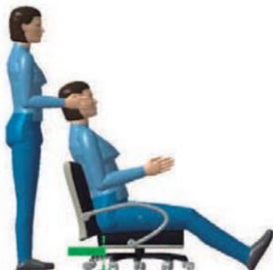
**Ilustración 47. Percentil 5 de técnico y percentil 95 de cliente con regulación a la altura de los codos flexionados**
