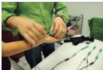
Ilustración 13. Detalle de la colocación de los electrogoniómetros
