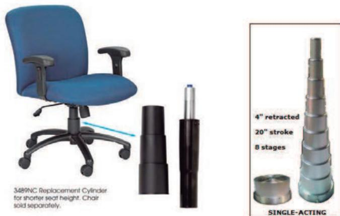
Ilustración 50. Detalle de cilindros de configuración telescópica para aumentar el rango de regulación. El modelo de la derecha permite una regulación mínima de 101,6 mm, y una máxima de 508 mm.
