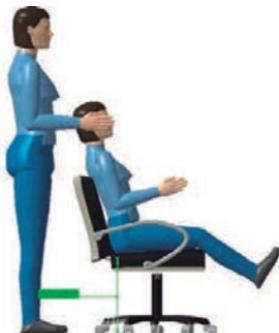
**Ilustración 48. Percentil 95 de técnico y percentil 5 de cliente con regulación a la altura de los codos flexionados**
